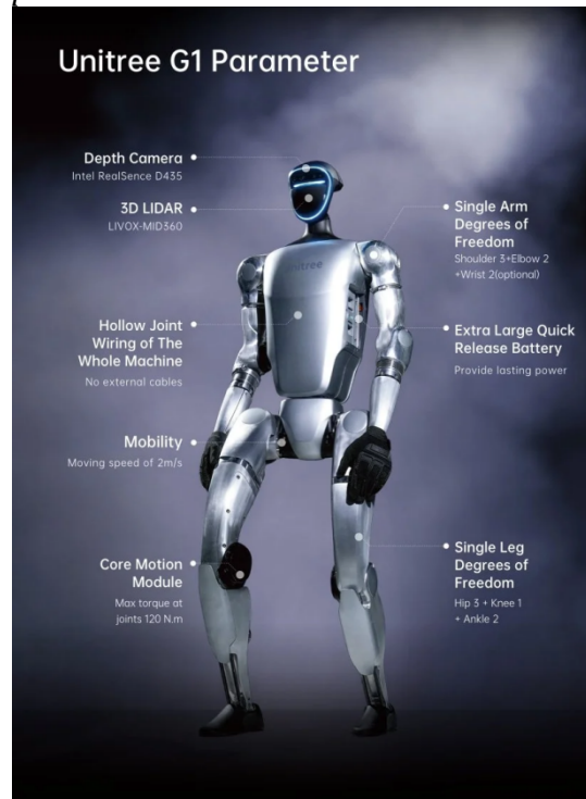
Figure 4.1: Unitree G1 Humanoid Robot Parameter
