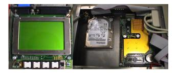
FIGURE 2.6: left: *EyeBot* controller, right: mini PC [39].
