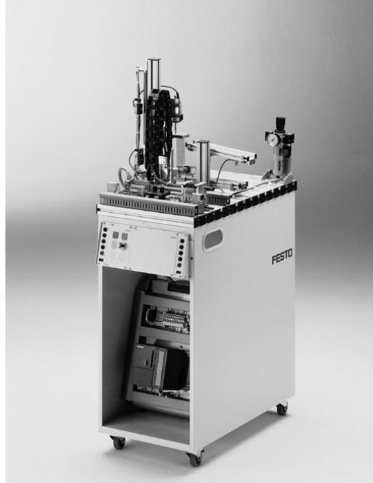
Station Prüfen mit Wagen, Bedienpult und SPS Board
